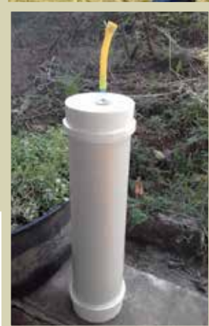
■ Coleta de amostra no momento de colheita do milho na Fazenda do cooperado Carlos Amorim, realizada em parceria entre a equipe técnica da Coopersete e da Emater. Ao lado, mini-silo utilizado para coleta e armazenagem das amostras de silagem encaminhadas ao laboratório de bromatologia da CCPR
